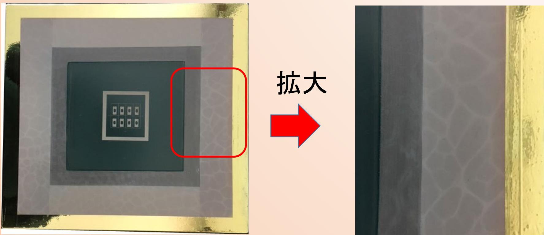
高位置精度用コンビネーションの特殊ポリエステルメッシュは、通常均等に織られています。ポリエステルメッシュを後加工することにより部分的に開口部を狭く(例 230# 約35%減少)する事で、その部分の強度が増すことにより、印刷時(スキージング)に加わる力を分散させる事で位置精度を向上させます。
